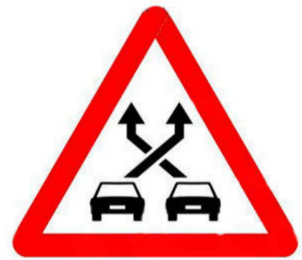
Trenzado. Bifurcación donde se producen cambios de carril con automóviles que cruzan sus trayectorias.
